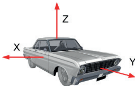
Рис. 6.13. Система координат, используемая для API -датчика [130]
